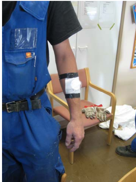
Kuva 5. Keräinlappujen kiinnitys saappaaseen ja käsivarteen Sulkavan linjatyömaalla 18.8..
