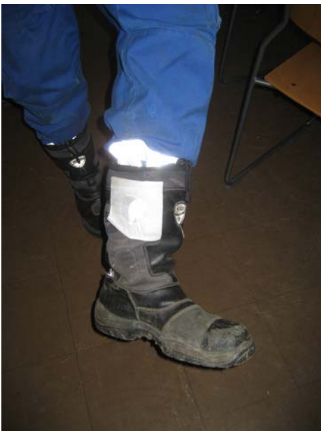
Kuva 5. Keräinlappujen kiinnitys saappaaseen ja käsivarteen Sulkavan linjatyömaalla 18.8..
